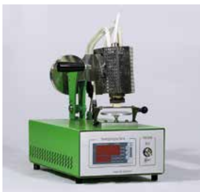
Аппарат для определения устойчивости подошвы к контакту с горячими поверхностями
