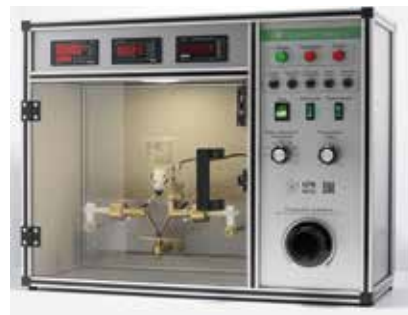
Установка для проверки стойкости к образованию токоведущих мостиков (трекинговость)
