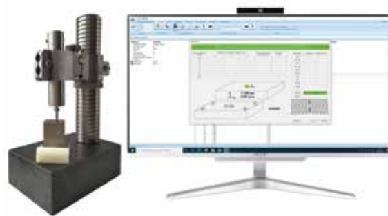
4-я модификация компаратора ПКМ-100 для поверки концевых мер длины
